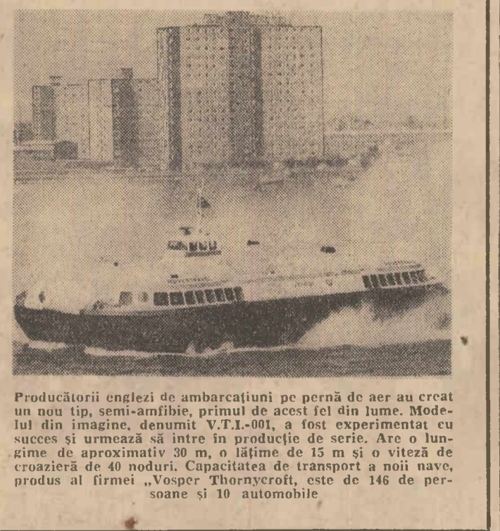
Producătorii englezi de ambarcațiuni pe pernă de aer au creat un nou tip, semi-amfibiu, primul de acest fel din lume. Modelul din imagine, denumit V.T.I.-001, a fost experimentat cu succes și urmează să intre în producție de serie. Are o lungime de aproximativ 30 m, o lățime de 15 m și o viteză de croazieră de 40 noduri. Capacitatea de transport a noii nave, produs al firmei „Vosper Thornycroft”, este de 146 de persoane și 10 automobile
