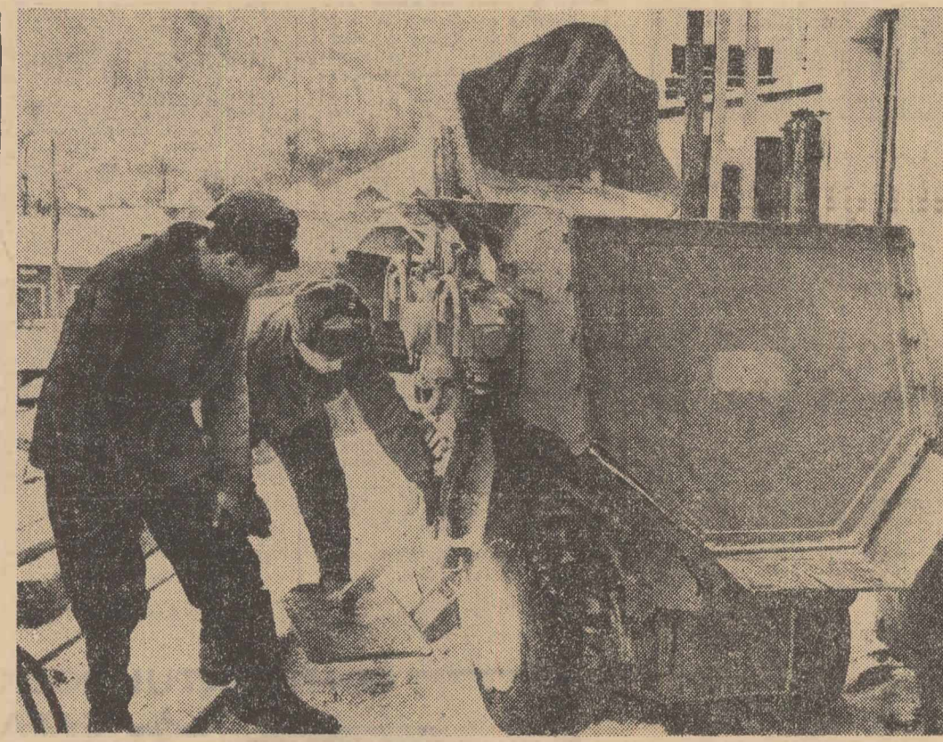
La întreprinderea minieră Fundul Moldovei lucrările din subteran sînt efectuate cu mijloace de transport mecanice alăt pe orizontală și pe verticală la susținerea lucrărilor miniere de deschidere și pregătire se folosesc armăturile metalice. În cliseu: tehnicianul Gh. Humoreanu și lăcătușul Virgil Brustur pregătesc o mașină de încărcat cu siloz pentru a fi transportată în mină
