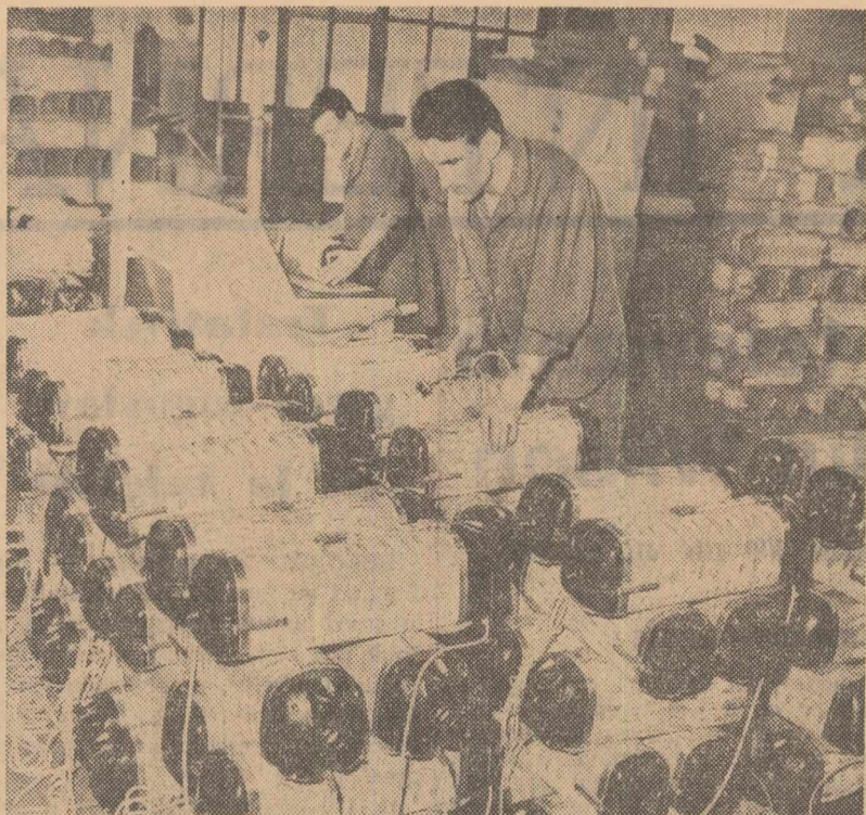
La întreprinderea „Electromotor”-Timişoara, în sectorul micro-motoare şi aparate electrocasnice se fabrică şi aspiratoare de praf „Record”. De curînd, aici s-a introdus rodajul pe bandă, precum şi bobinarea rotoarelor cu maşina, ceea ce duce la o îmbunătăţire substanţială a calităţii aspiratoarelor. În clădire: Monitorul Grigore Demian verificînd un nou lot de aspiratoare
