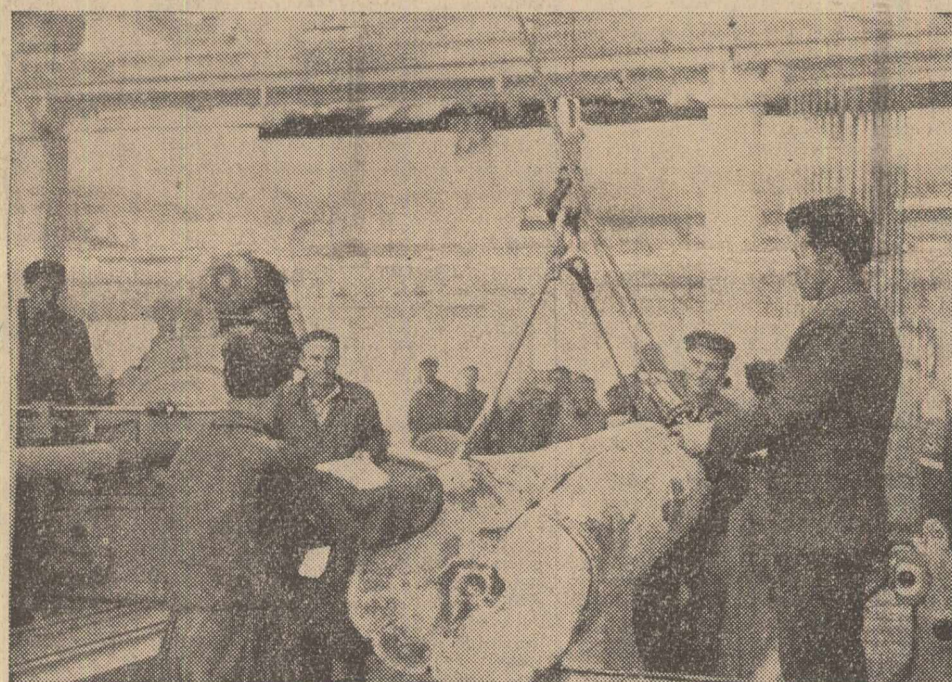
La mașina de derulare sînt introduși pentru probe și transformați în furnire primii bușteni
